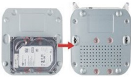
2. Priskrutkujte HDD k spodnému panelu pomocou skrutiek.
