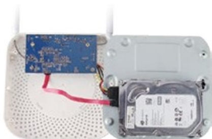
3. Pripojte pevný disk pomocou príslušných káblov.
