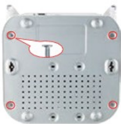
1 Odskrutkujte 4 fixačné skrutky a potom odstráňte horný kryt.
